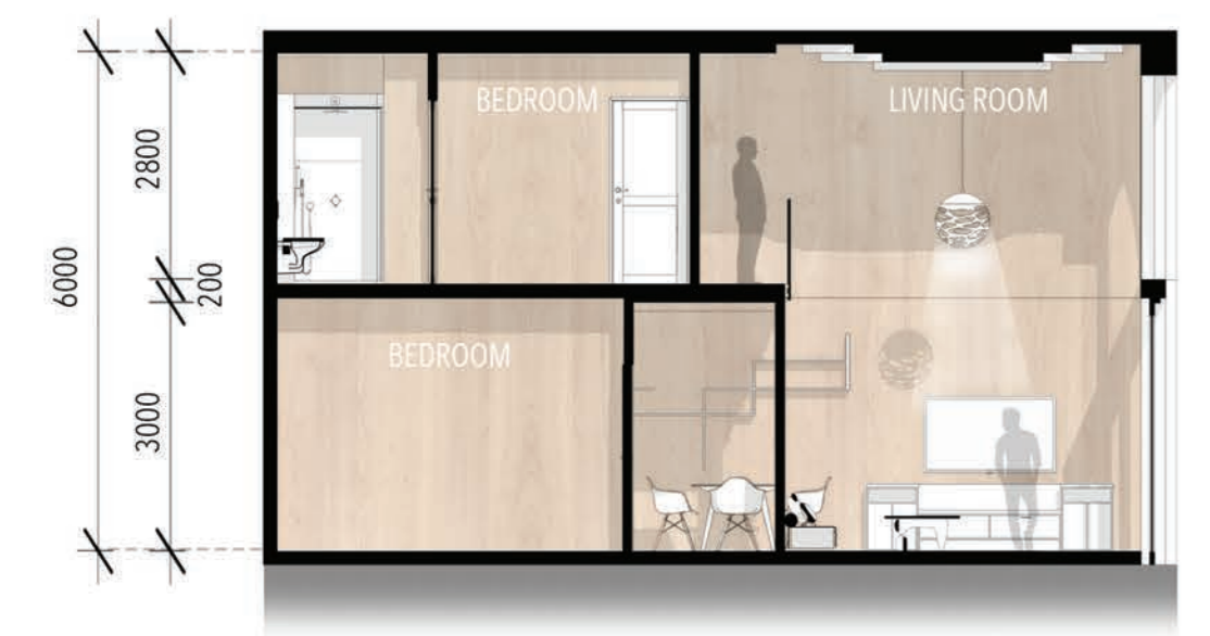
2 BED UNIT : LONGITUDINAL SECTION SCALE 1:100
