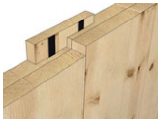
DETAIL OF A LONGITUDINAL JUNCTION 124, 84 – WITH FASTENER / Detalle de junta longitudinal 124, 84 - con placa junta
