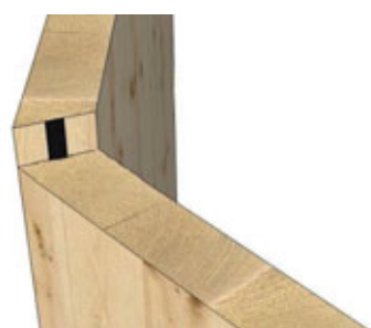
DETAIL OF CORNER JUNCTION (cca 135° and more), IW 124, 84, 62 / Detalle de junta angular (aprox. en el ángulo de 135° o en ángulos más grandes), PI 124, 84, 62
