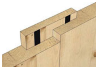
DETAIL OF A LONGITUDINAL JUNCTION 62 – WITH FASTENER / Detalle de junta longitudinal 62 - con placa junta
