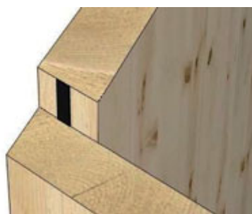
DETAIL OF CORNER JUNCTION (cca 135° and more), IW 124, 84, 62 / Detalle de junta angular (aprox. en el ángulo de 135° o en ángulos más grandes), PI 124, 84, 62
